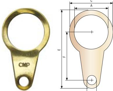
**Кольца ET** служат для организации местного заземления. Установленные между кабельным вводом и оборудованием обеспечивают надежное гальваническое соединение в цепи заземления. Изготавливаются из латуни или никелированной латуни. Также возможно изготовление колец заземления из альтернативного материала по требованию.
