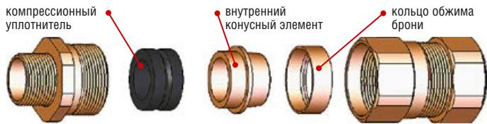
В типичном кабельном вводе используется компрессионный уплотнитель. Как показано ниже, повреждение кабеля может быть вызвано неконтролируемым чрезмерным затягиванием нажимной гайки кабельного ввода, поскольку отсутствует встроенная функция предотвращения такой ситуации.
