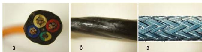
Рис. 4-5. Пример конструкции кабеля, который не всегда подходит для использования в зонах повышенного риска
