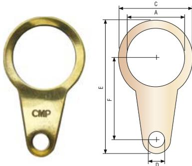
Кольца ET служат для организации местного заземления. Установленные между кабельным вводом и оборудованием обеспечивают надежное гальваническое соединение в цепи заземления. Изготавливаются из латуни или никелированной латуни. Также возможно изготовление колец заземления из альтернативного материала по требованию.
